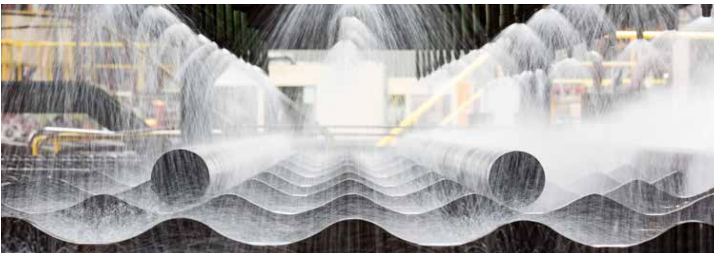
Abb.: Rohrkühlung mittels Wasserbrause
