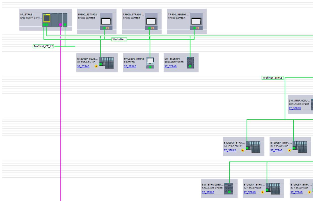
Ein Datenaustausch mit anderen Steuerungen ist über ein separates Netzwerk auf Basis ProfiNet (I-Device) oder über PN/PN-Koppler zu realisieren.
