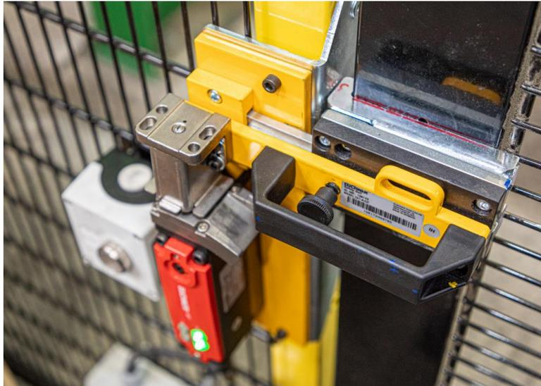
Nach der Anmeldung werden die zugehörigen Aggregate automatisch in eine sichere Position verfahren. Danach wird die Verriegelung des Zutritts aufgehoben und die Tür kann geöffnet werden. Nach Abschluss der Arbeiten im Sicherheitsbereich, muss die Tür geschlossen und durch Drücken der Anmeldetaste wieder verriegelt werden.
