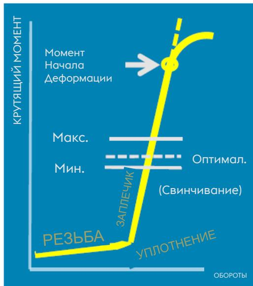
Момент начала деформации: точка перехода из эластичной в пластичную зону
