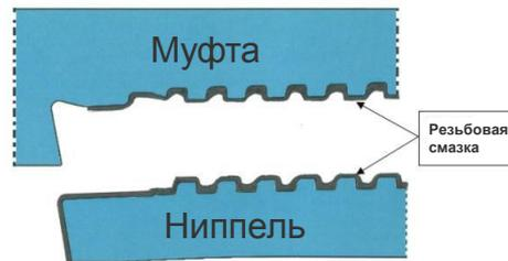
Рекомендована модифицированная резьбовая смазка по стандарту API с известным коэффициентом трения между 0,8 и 1,2. Смазку наносят равномерно на ниппель и муфту (на ниппеле, включая зону уплотнения и заплечик).
