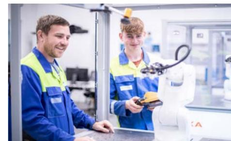
Beim Robotik-Kurs werden dir die Grundlagen der Roboterprogrammierung auf eigenen Schulungszellen (Industrieroboter in Kleinformat) vermittelt. Diese umfassen verschiedene Aufgabenstellungen aus der Praxis und du lernst dabei den Umgang mit dem Smart Pad (Bedienpanel). Ebenso werden dir die grundlegenden Funktionen eines Robotik-Systems sowie dessen Kinematik (6 Achsen) vermittelt. Dabei lernst du auch das spezielle Zubehör wie Greifer und Werkzeuge etc. kennen und anzuwenden.
