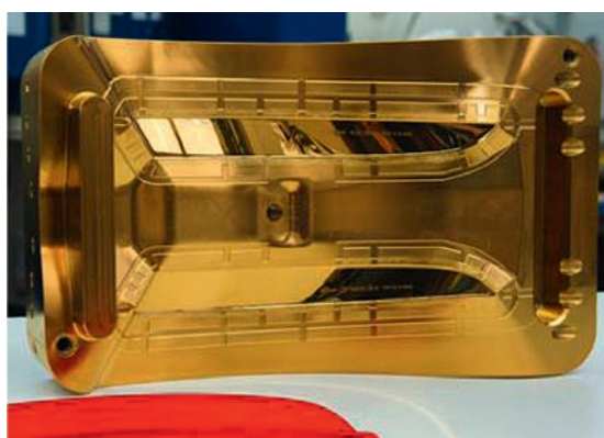
Eine mit TiN-ultrafinebeschichtete Form für den Einsatz im Kunststoffspritzguss (vorne die gefertigte Kunststoff-Blende für den Automobilbereich).
