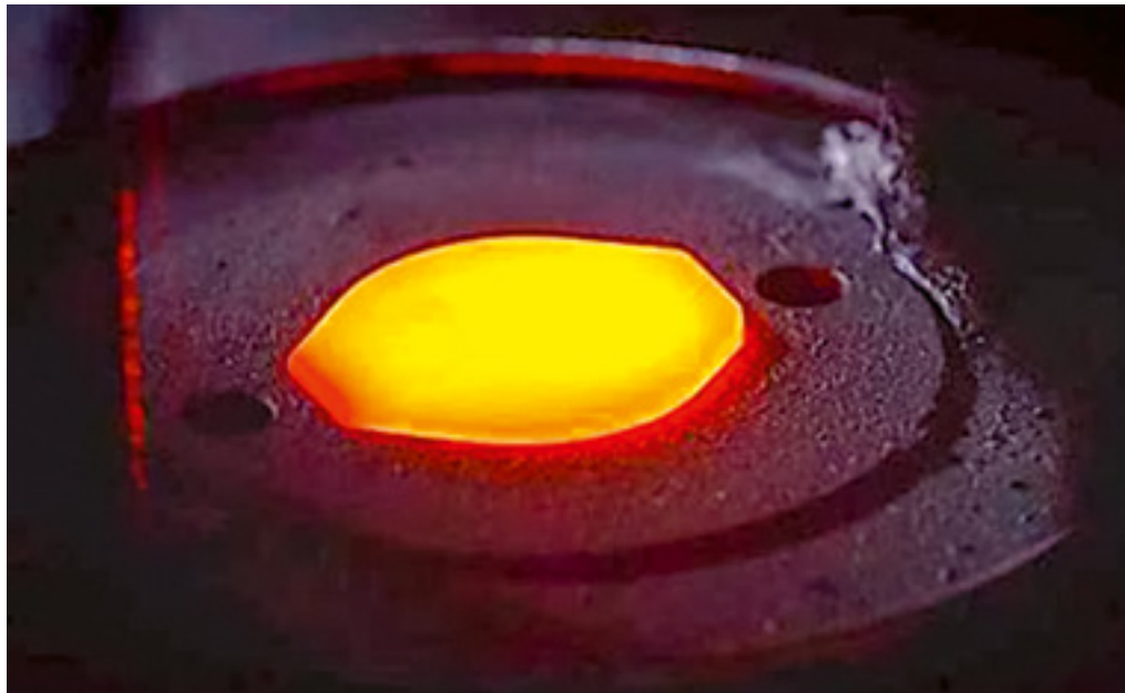
Carrure en BÖHLER P570 placée dans une matrice en acier BÖHLER W360
