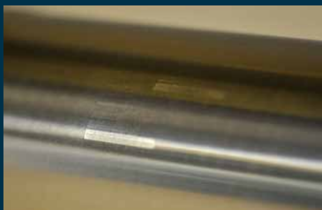
g) Kennzeichen: Parallel zur Werkstückachse auftretende Facetten (teilweise oder über den ganzen Umfang)
