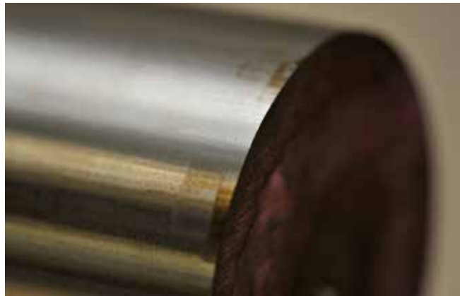
e) Kennzeichen: Spiralförmige oder örtlich gelbe oder braune Verfärbung der Oberfläche
