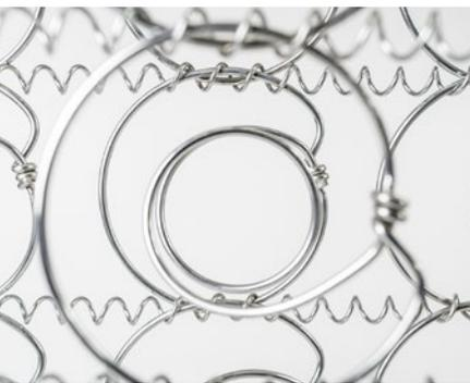
Forme d'escargot caractéristique : un ressort prêt à l'emploi fabriqué dans une machine à transfert Bonnell.
