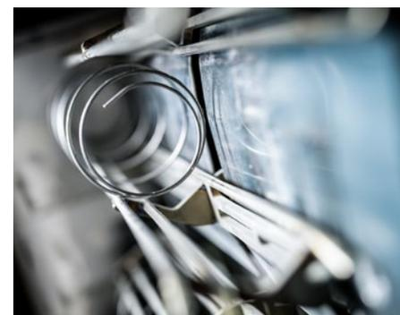
Kaum zu glauben, dass man auf solchen Drahtfedern später bequem liegen kann: fertige Drahtfeder nach dem Windevorgang.
