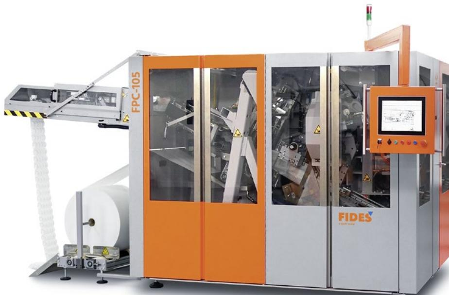
geschieht vollautomatisch: In verschiedenen Arbeitsschritten werden die Federn gehärtet, gewunden, wärmebehandelt und mit einem Spiraldraht verbunden.
