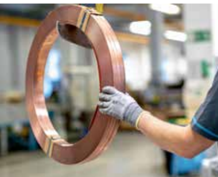
Rouleau de bandes bimétalliques, en route pour la prochaine étape du processus.
