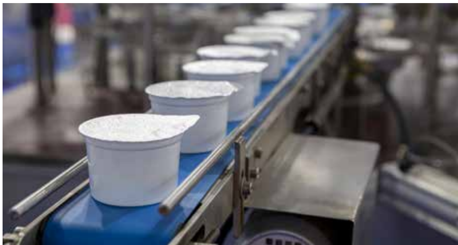
Des pots de yogourt remplis et fermés à la fin d'une ligne de production.
