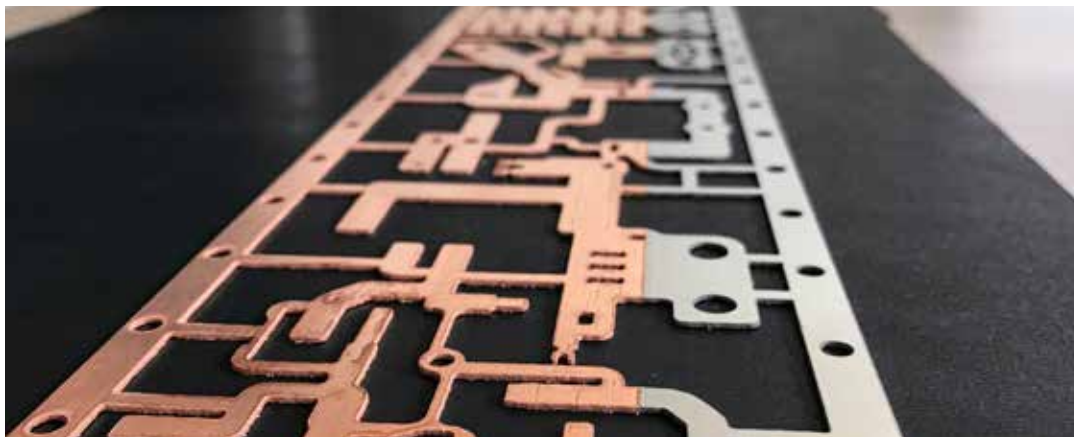
Connexion enfichable constituée d'une connexion cuivre-acier.
