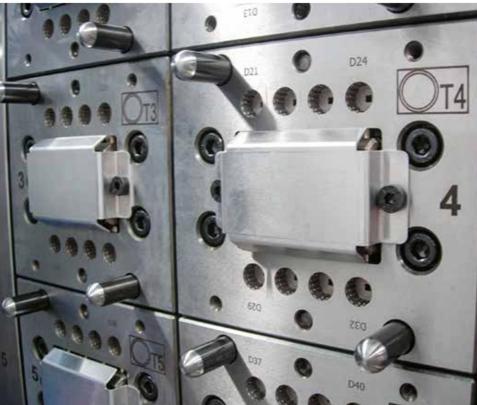
Moule d'injection en BÖHLER M368 MICROCLEAN pour la fabrication de porte-canule pour l'YpsoPen.
