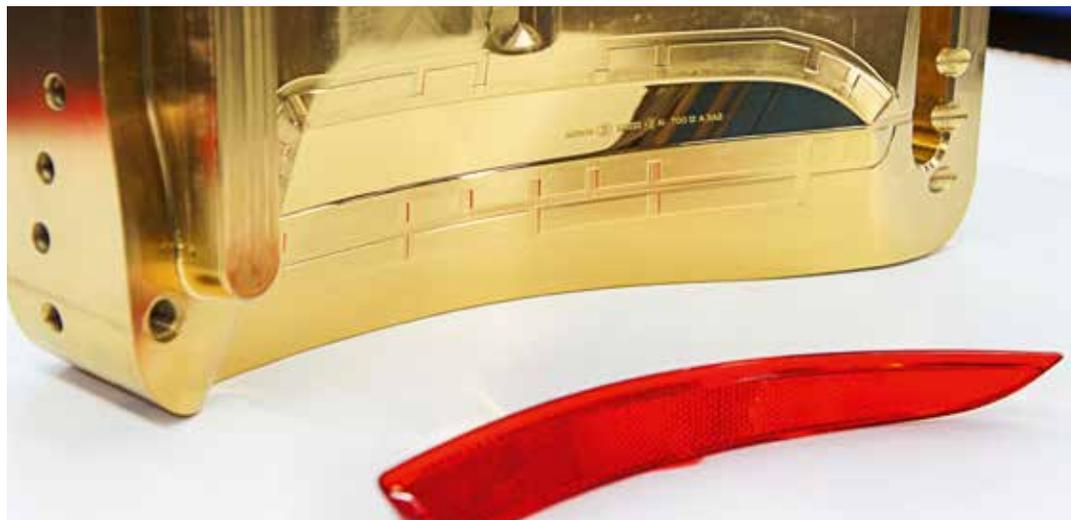
Moule revêtu de TiN-ultrafine pour le moulage par injection de matières plastiques (au 1er plan le cache plastique fabriqué pour le secteur automobile).
