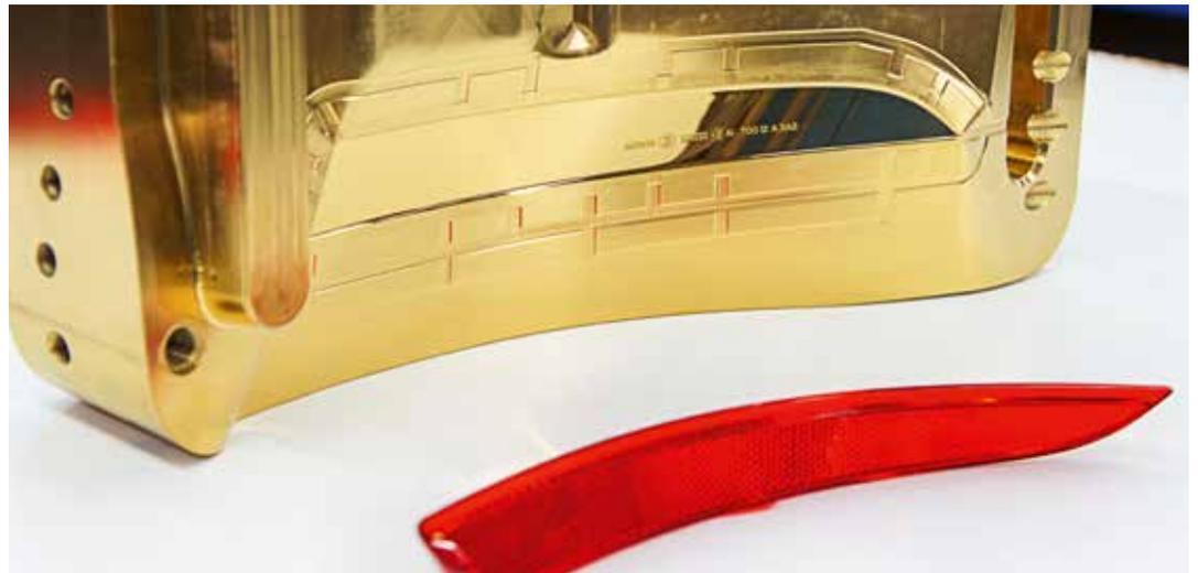
Eine mit TiN-ultrafine beschichtete Form für den Einsatz im Kunststoffspritzguss (vorne die gefertigte Kunststoffblende für den Automobilbereich).
