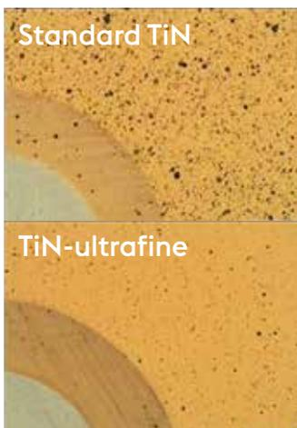
Oberfläche mit Kalottenschliff einer Standard TiN (oben) und einer TiN-ultrafine.
