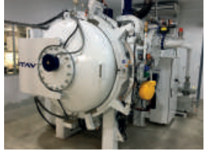
Horno al vacío en Lima para temple de aceros para herramientas
