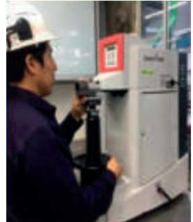
Medición de dureza en durómetro de banco digital
