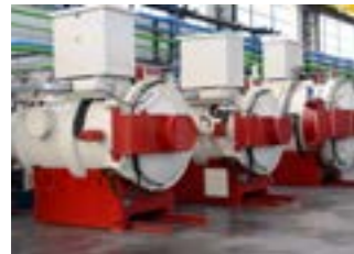
Wärmebehandlungsöfen zum Vakuumhärten
