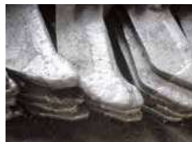
Blindaje de cuchillas y martillos desfibreadores
