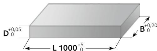
**Präzisionsflachstahl mit Bearbeitungsaufmaß**
