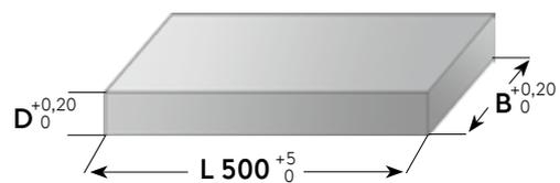
**Präzisionsflachstahl mit Bearbeitungsaufmaß**
