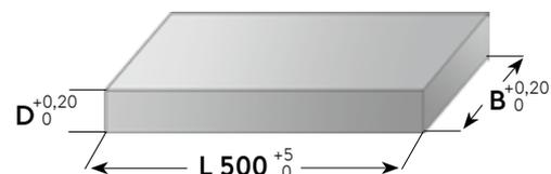
**Präzisionsflachstahl mit Bearbeitungsaufmaß**
