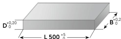
**Präzisionsflachstahl mit Bearbeitungsaufmaß**
