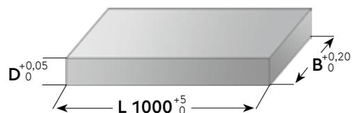
**Präzisionsflachstahl mit Bearbeitungsaufmaß**
