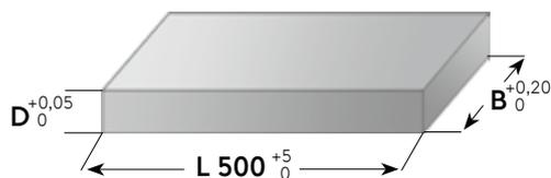
**Präzisionsflachstahl mit Bearbeitungsaufmaß**
