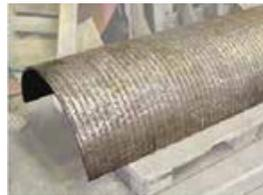
Recubrimiento de piezas sometidas a alta abrasión
