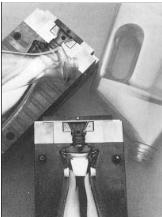
Dos mitades de un molde de soplado realizado con la aleación Coolmould HH de cobre berilio.
