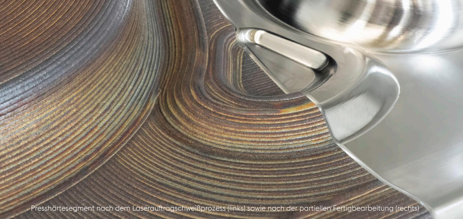
Presshärtesegment nach dem Laserauftragschweißprozess (links) sowie nach der partiellen Fertigbearbeitung (rechts)
