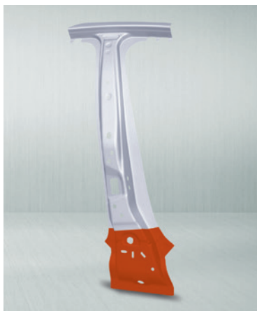
Lokal weicher Bereich
