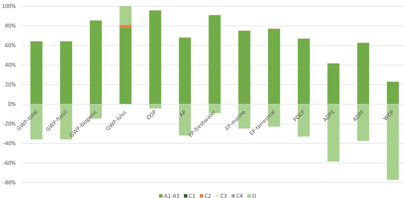
Stellt man die einzelnen Phasen gegenüber, so ergibt sich eine klare Dominanz der Produktionsphase (Module A1–A3). Die Umweltwirkung in der Produktionsphase ist hauptsächlich von den direkten Prozessemissionen der Stahlproduktion und der Wertschöpfungskette der zugekauften Rohstoffe und Energieträger dominiert.
