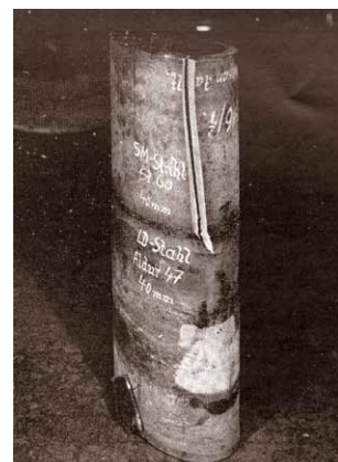
Biegeversuch mit einem halben Rohrschuss, Durchmesser 1.200 mm, zusammenschweißt aus einem LD-Baustahlblech Aldur 47 von 40 mm Dicke (52 kg/mm 2 Zugfestigkeit) und einem sprödebruchempfindlichen SM-Stahlblech St 60. Der beim Biegeversuch eingetretene plötzliche Bruch wurde hart an der Schweißnaht vom LD-Stahlblech abgefangen. 51
